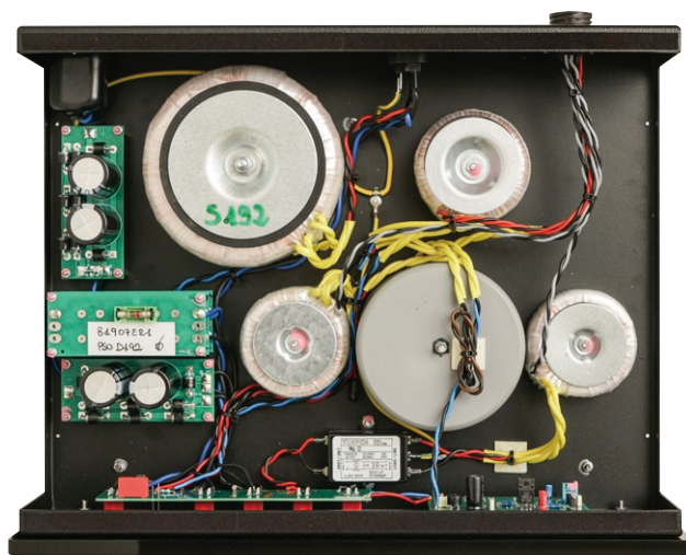
▲PSU-DC192分體電源器內部結構
